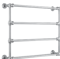
983A - 3/4" Sèche serviettes à 4 barres sans robinets, avec purgeur: Entraxe verticale (fixe): 690 mm Entraxe horizontale (variable): 800 mm
