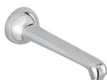
0/3229 - 1/2" Bec mural fixe avec filetage femelle 1/2" longueur 215 mm
